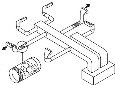
Extracción ó inyección por conducto individual.
